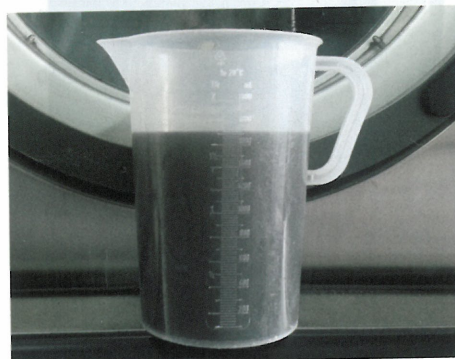
Das erste Waschwasser einer Überjacke, die bei einem Brandeinsatz in einem Holzkohle verarbeitenden Betrieb getragen wurde.
